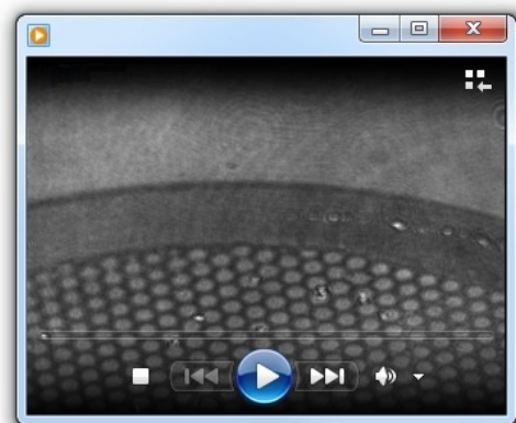
Abb. 97: Aufgezeichnete Videodatei bei linearer Potenzialänderung E(t) einer zyklischen Voltmetrie der strukturierten Goldelektrode bei gelöster Redoxspezies.
