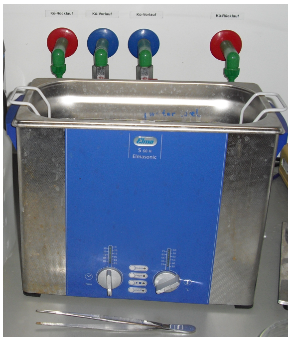
Abb. 40: Ultraschallbad zur Substratreinigung
