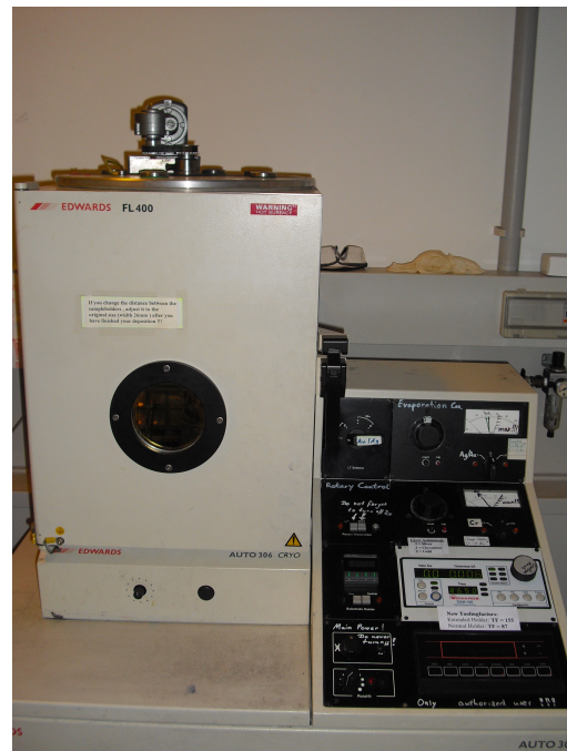
Abb. 41: Verdampfungsanlage zur Sensorbeschichtung
