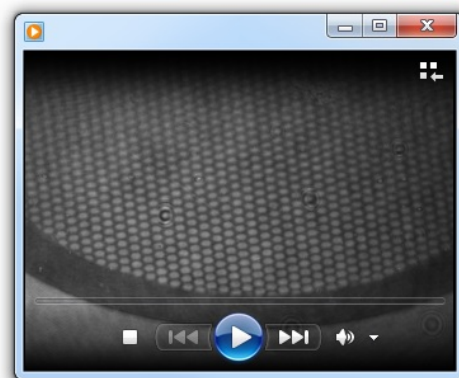
Abb. 92: Aufgezeichnete Videodatei bei linearer Potenzialänderung E(t) einer zyklischen Voltammetrie der strukturierten Goldelektrode
