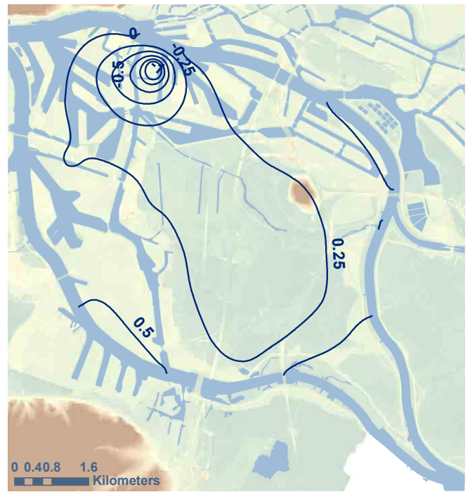
Abb. 64: Mittlere Grundwassergleichen [m NHN] für den Zeitraum 1997 bis 2007 (Modellergebnis; eigene Darstellung Meier).
