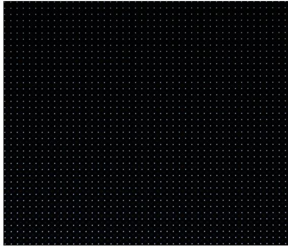
**Abbildung 4.4:** Messung zur Abstandskalibration zwischen Mikrolinsenarray und Makroobjektiv/Relaylinse. Mit Hilfe einer Mikrometerschraube wird das Mikrolinsenarray so lange verschoben, bis die Ausdehnung der Punkte minimal wird. Das Limit entspricht dabei der Größe des ersten Beugungsscheibchens.
