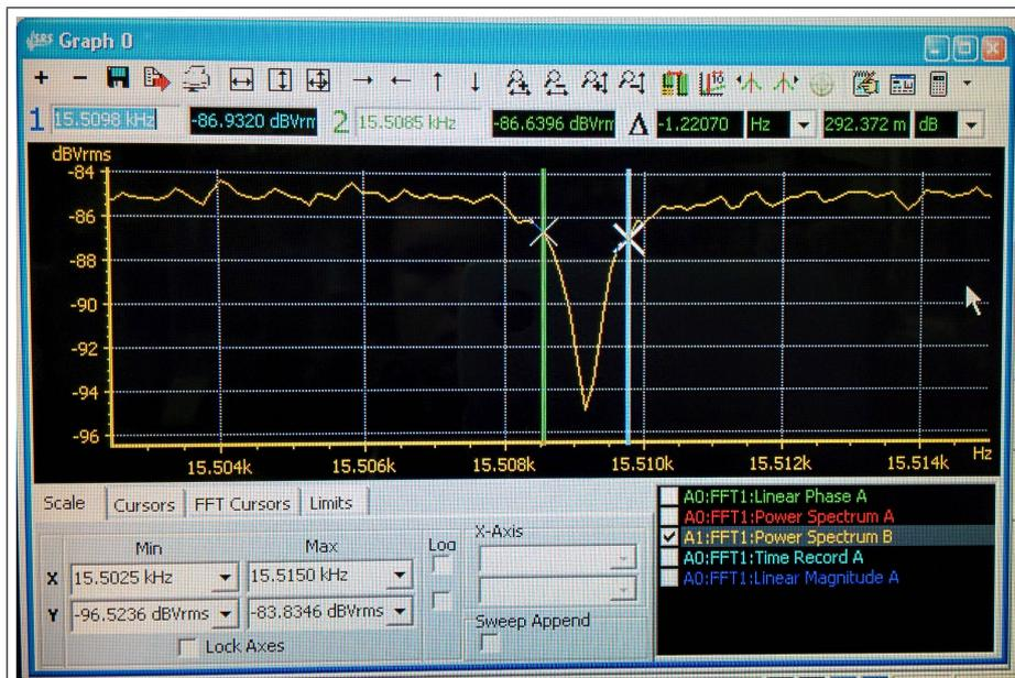
Abbildung 24: Foto der Messung in Mainz. Auf dem Bild ist der durch das Ion verursachte Dip der Frequenzmessung in der Präzisionsfalle während der Versorgung durch LoCepps zu sehen.
