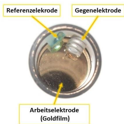
Abb. 3.8 - Elektrodenanordnung in elektrochemischer Messzelle.
