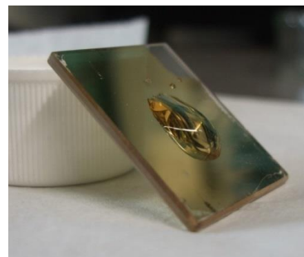
Abb. 4.19 - Mit Gold beschichtetes Glassubstrat. Der Bereich in der Mitte war 4 Stunden in Kontakt mit Schwefelsäure und ist durch die Absorption von Sulfat hydrophil geworden. Der Wassertropfen haftet selbst bei 45° Neigung noch an der Oberfläche. An den Randbereichen perlt das Wasser ab.
