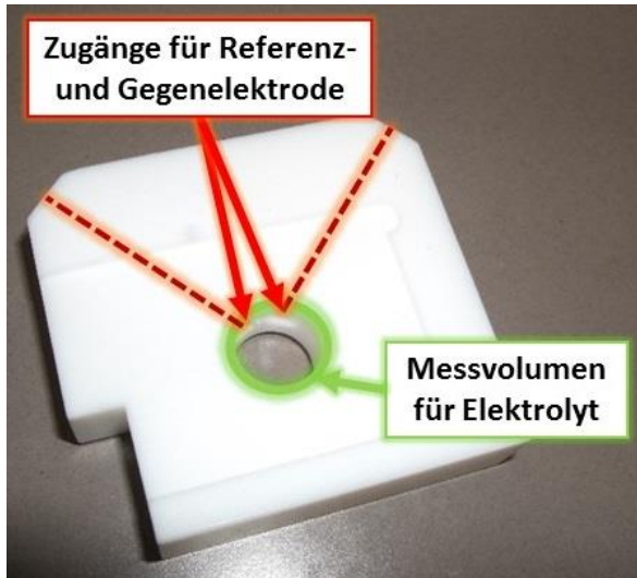
Abb. 3.7 - Elektrochemische Messzelle aus Teflon. Volumen: 785 \mu\text{L} .
