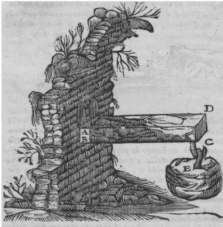
Figure 2. Galileo's cantilever model. From Galileo, Discorsi e dimostrazioni matematiche intorno à due nuove scienze, attenenti alla Meccanica, & I Movimenti Locali (Bologna, 1655), 86. Permission: Library of the Max Planck Institute for the History of Science, Berlin.
