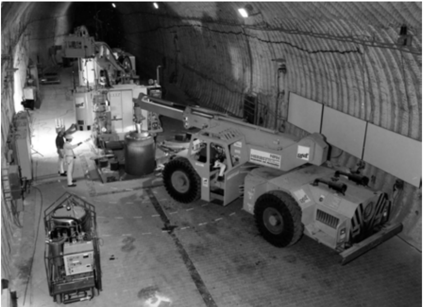
Abbildung 4.8: Erprobung eines Einlagerungssystems für hochradioaktive Abfälle [27]
