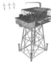
Abbildung 2.5: HGÜ zur Offshore-Anbindung
