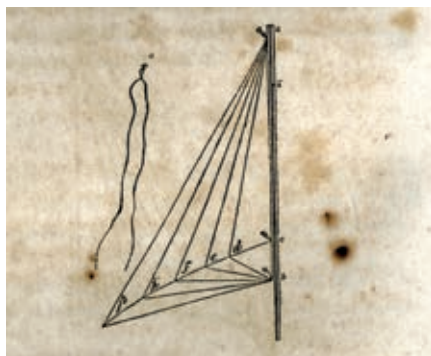
Figura 10.6: Strumento a fili per disegnare l'iperbole. Da Meditatiunculae , Bibliothèque Nationale, Parigi.
