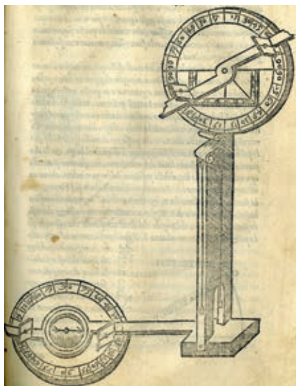
Figura 10.10: Il teodolite di Cosimo Bartoli. Del modo di misurar , Venezia 1589. Bibl. Oliveriana, Pesaro.
