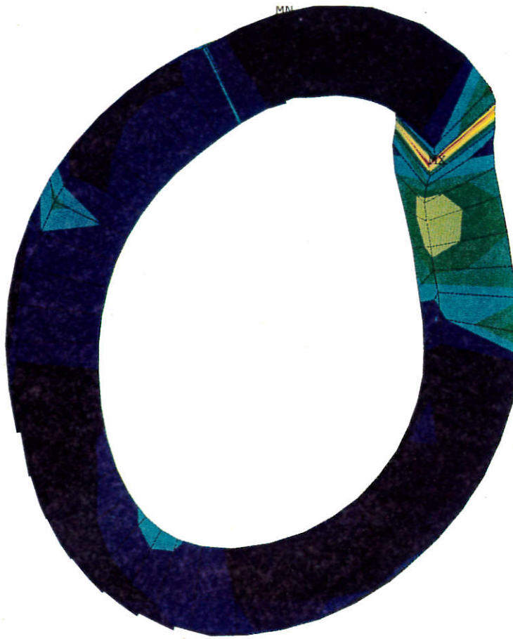
Bild 15: Vergleichsspannung nach der Hypothese "Von Mises" Spule 3 - ANSYS Element Type 52 2. Iteration
