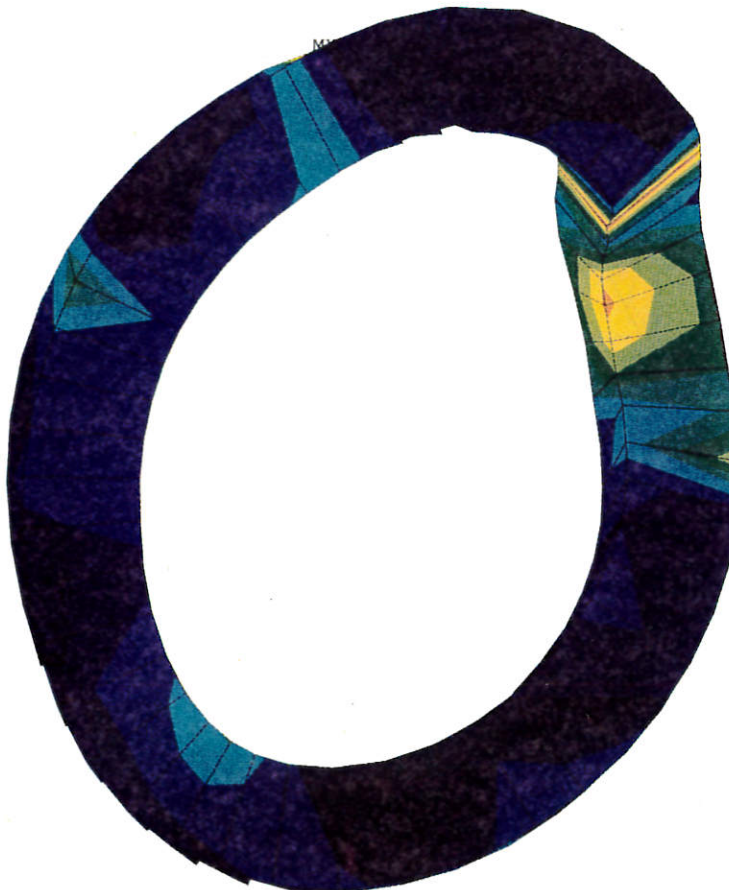
Bild 16: Vergleichsspannung nach der Hypothese "Von Mises" Spule 3 - ANSYS Element Type 52 3. Iteration
