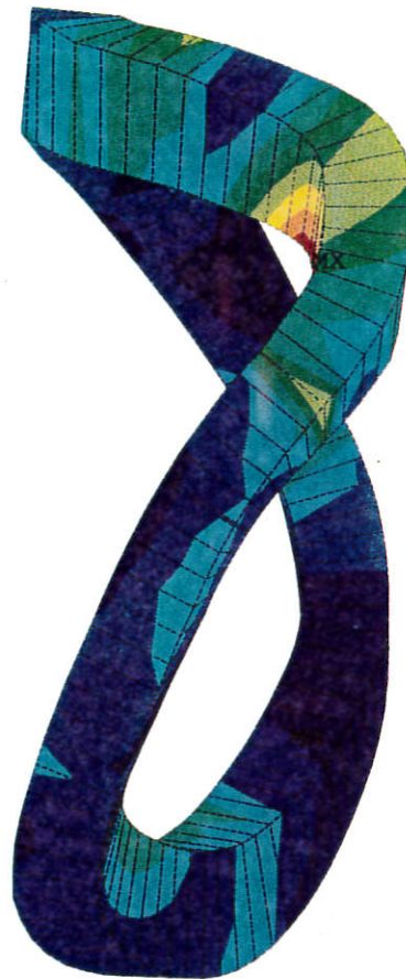
Bild 91: Spulenspannungen SIGE - Spule 3 - Isotrop - Ohne radiale Abstützung 8-Knoten Solid-Elemente SIGE max.= 373 MPa
