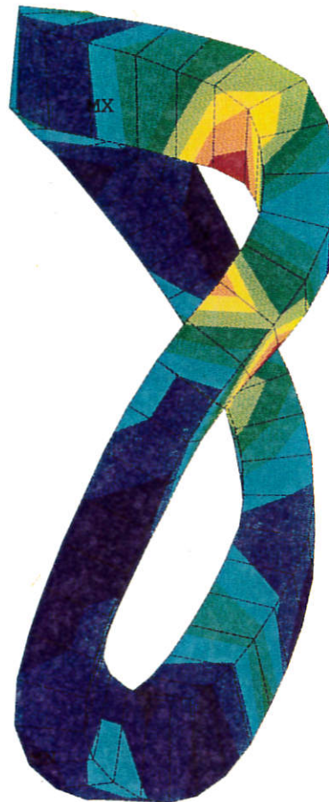
Bild 95: Spulenspannungen SIGE - Spule 3 - Isotrop - Mit radialer Abstützung 20-Knoten Hexa-Elemente SIGE max.= 175 MPa
