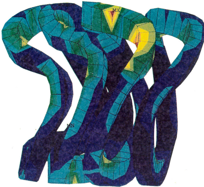
Bild 62: Spulenspannungen SIGE (Vergleichspannung) Das Maximum liegt in Spule MF3 - ( 323 MPa )
