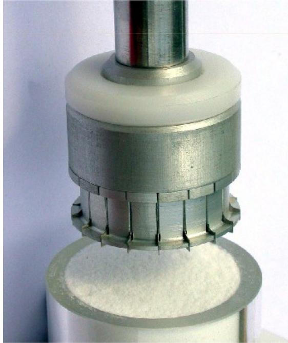
Abbildung 3.11: Scherzellenmodell der Firma Freeman Technology<sup>11</sup>.
