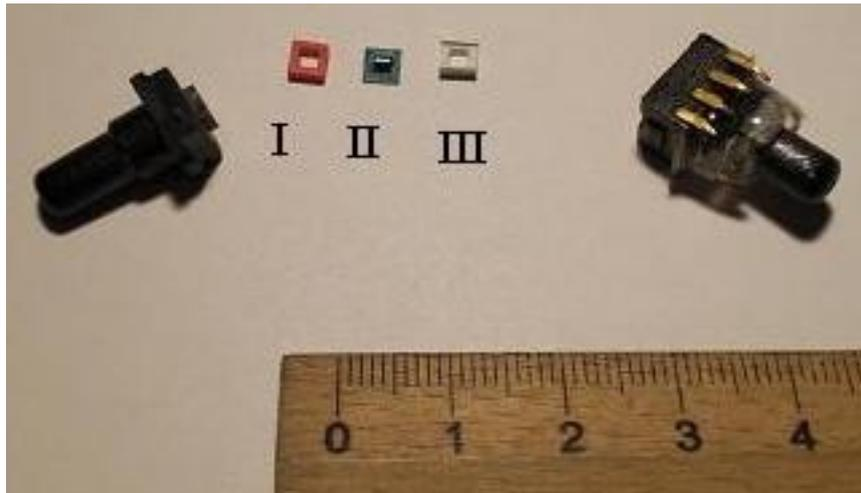
Abbildung 4.2: Explosionsdarstellung eines defekten Drucksensors
