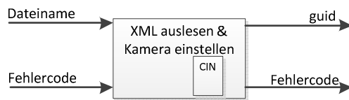
Abbildung 9 Konzeptioneller Ausbau des VIs zum Einstellen der Kamera
