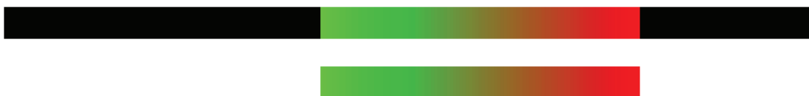
Abbildung 3.6: Beispiel Transferfunktion als Grafik. Die X-Achsen definieren den Datenwert, die Y-Achsen jeweils Rot, Grün, Blau und Alpha (Schwarz). Oben ohne Alpha-Kanal. Unten mit Alpha-Kanal, die schwarzen Ränder der Transferfunktion werden Transparent.
