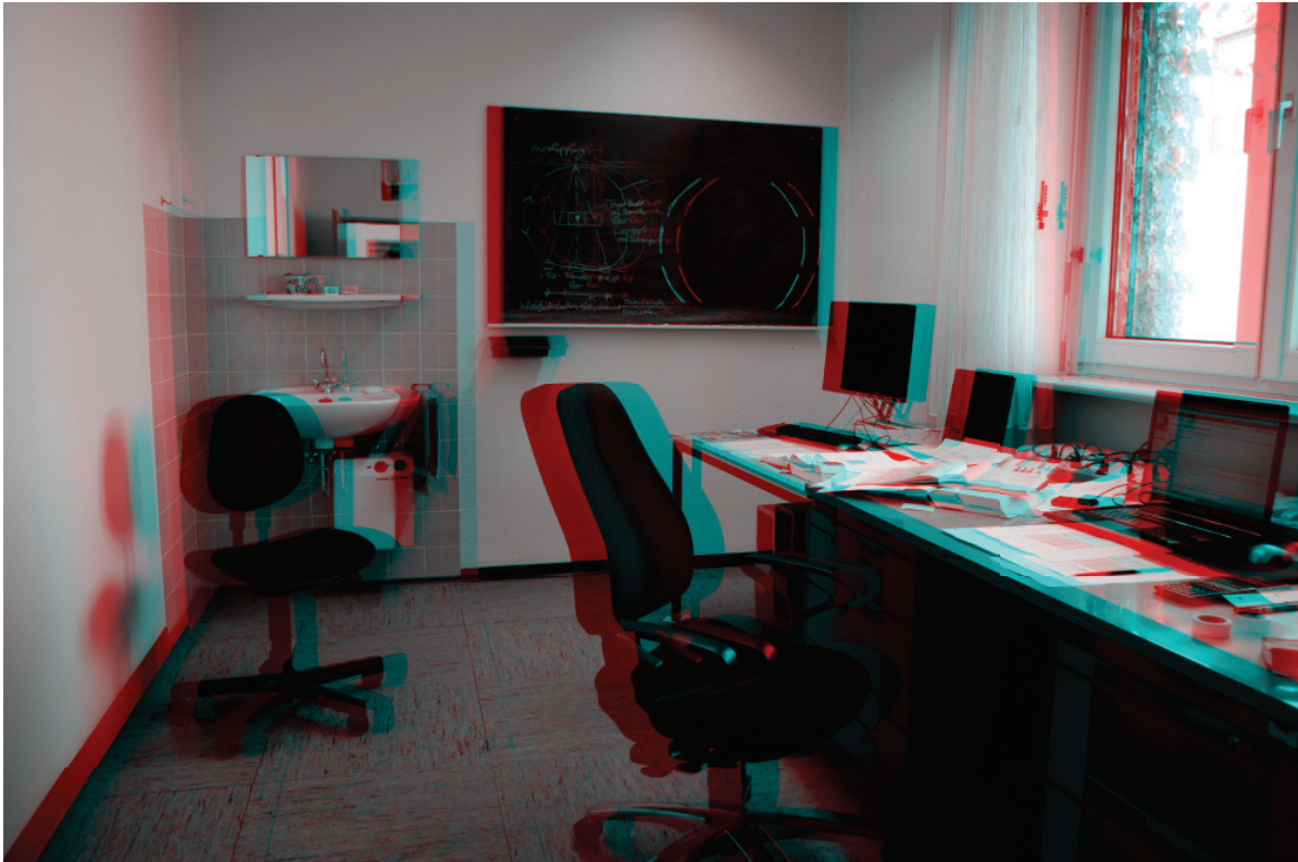
Abbildung A.3: Aufgenommen mit einer Stereobasis von 7cm. Die Blickachse der Kamera wurde um die Stereobasis parallel verschoben, der Fixpunkt liegt also im Unendlichen.
