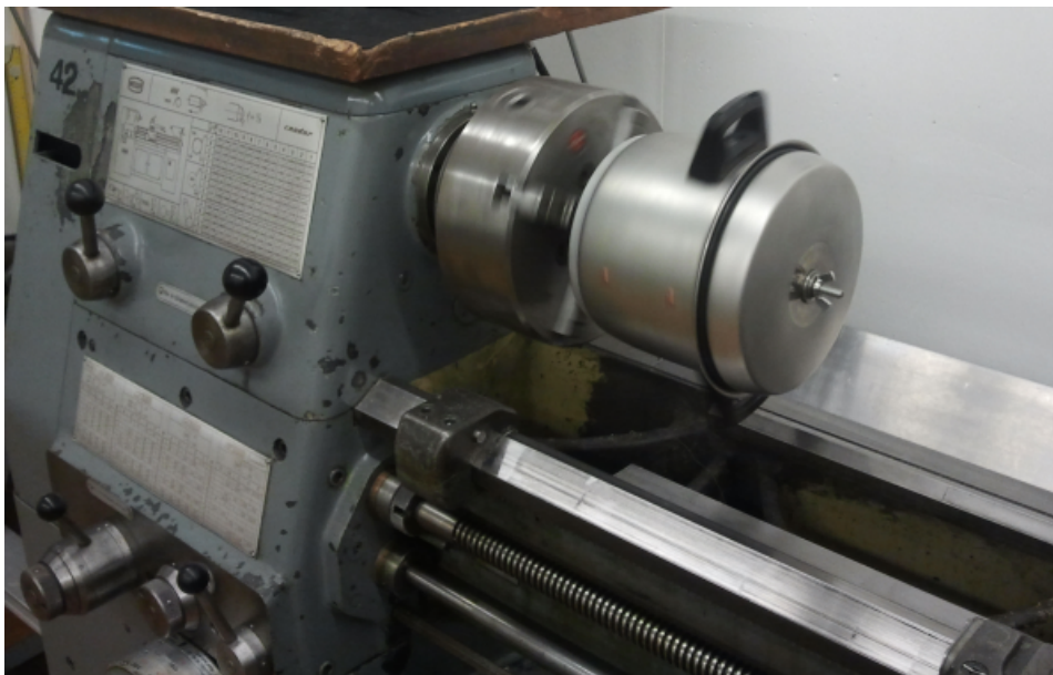
Abbildung 3.6.: Die Teilchen werden zusammen mit dem entsprechenden Schleifmittel in einen Topf gegeben, der auf einer Drehbank eingespannt wird.
