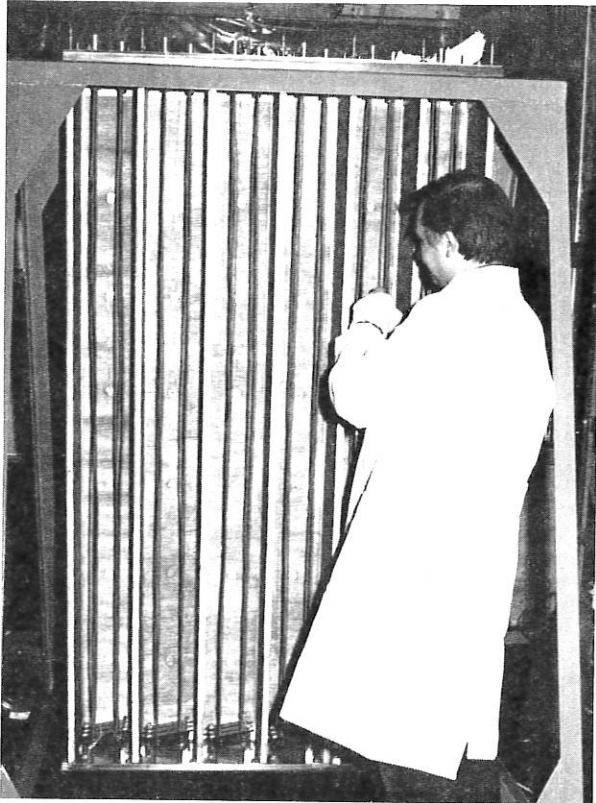
Abb. 1 Titanverdampferpumpe für die ASDEX-Neutralinjektoren
