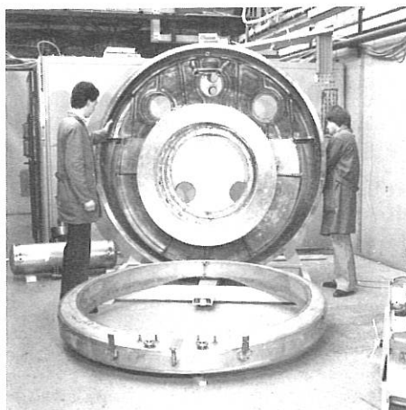
Abb.11 Die supraleitende Spule WVII mit Vakuumgefäß und Stickstoffschild und LN 2 -Vorratsbehälter während der Montage.
