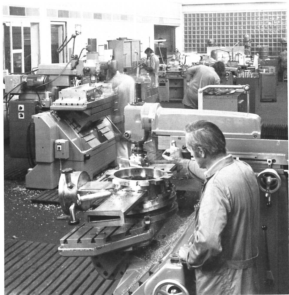
Abb. 3: Kreuzstück für PML-Torus: Das Werkstück ist zum Ausschlagen eines Zentrier- durchmessers, der für die Weiterbearbeitung auf einer Drehmaschine erforderlich ist, auf einem „Deckel“-Universal-Fräs- und Bohrwerk der Type FP3L aufgespannt . . .
