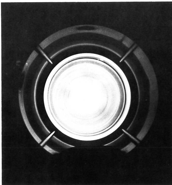
Abb. 1: End-on-Aufnahme des \Theta -Pinch-Plasmas
