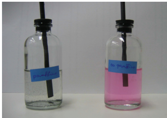
Abbildung 8. Oxidation des SRB-Mediums, verdeutlicht durch den Farbumschlag des Indikators Resazurin (rechts). Das Medium blieb reduziert, wenn der Graphitstab im oberen Teil mit Paraffin versiegelt wurde (links), was auch anhand der FeS- Präzipitate sichtbar ist.
