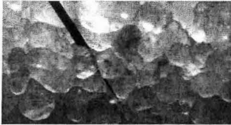
Abbildung 1.3: Faseroptischer Sensor zur Bestimmung der räumlichen Photonflußrate in einer Sedimentprobe. Die Kugel am Ende der Glasfaser hat einen Durchmesser von 100\ \mu\text{m} .
