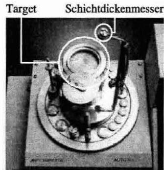
Abbildung 4.10: Blick unter die Vakuummotte der Edwards Auto 306 Sputteranlage mit Targethalter und Schichtdickenmesser.
