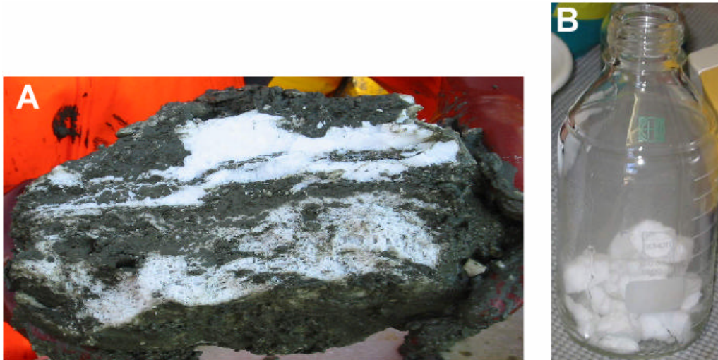
Abb. 4 (A) Sediment mit Einschlüssen von Gashydrat. (B) Reines Gashydrat bevor es geschmolzen wurde.
