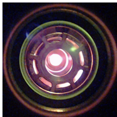
Abbildung 5.10: Aufnahme eines Elektronenstrahls auf dem YAG-Schirm (grüner Punkt). Deutlich zu erkennen ist der grüne Ring, der sich am Rand des Schirmes gebildet hat.
