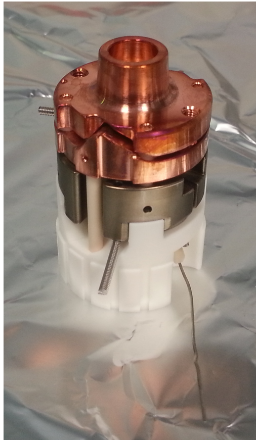
Abbildung 4.4: Übersicht der Kanone mit den gebogenen Schrauben als Anschlüsse für die elektrischen Zuleitungen.
