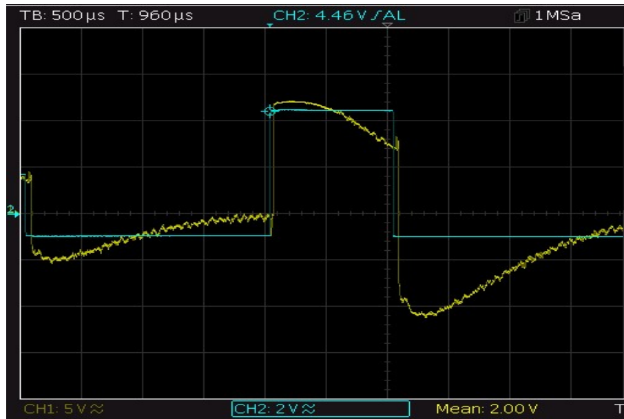
Abbildung 33: Bei diversen Einstellungen bildeten sich Resonanzen im Schwingkreis. Der Spannungsteiler war in dieser Messung noch nicht angeschlossen. Türkis: Spannungsverlauf des Pulsgenerators, Gelb: Spannungsverlauf der Pickupelektrode. Einstellungen: U_{Mount} = 2500V , Strom an der vertikalen/horizontalen Spule: I_{S_v} = 0A , I_{S_h} = 4,6A , U_A = 2500V , U_B = 0V , \mu_S = 1ms , d = 10ms , Gain = 1,5 , coarse\ gain = 1000 , t = 2\mu s .
