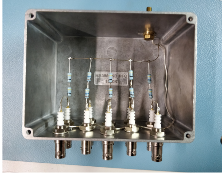
Abbildung 20: Box für die Lastwiderstände in der Ansicht von oben.
