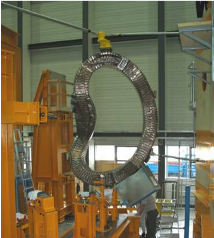
Befestigung der Spule über Spulenstandfüße und drei Gewindestangen
