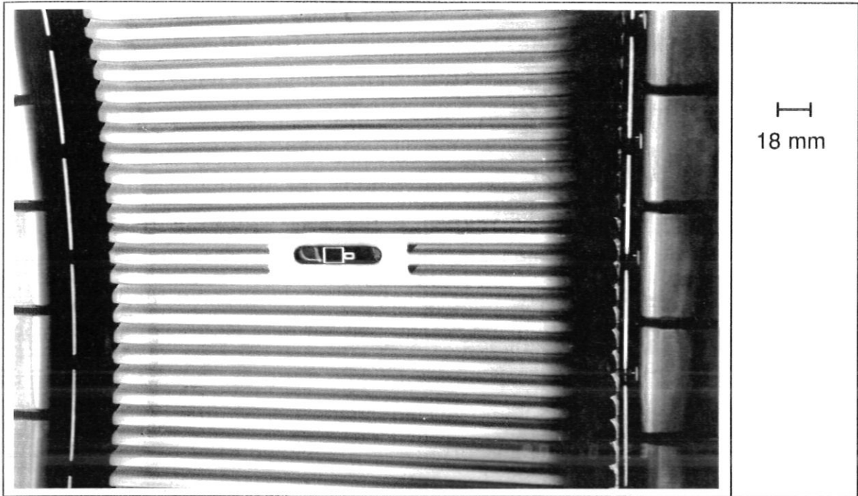
Abb.25 Mikrowellenantennen im Faradayschirm der ICRH-Antenne: In der endgültigen Version wurde die Antenne mit 10 mm x 8 mm Öffnung als Sender, das offene Hohlleiterende (3,8 mm x 1,9 mm) als Empfänger eingesetzt. Die Antennen schließen flach mit dem Faradayschirm ab und befinden sich somit 5 mm hinter der Limiterebene. Am Bildrand links und rechts sind die Antennenschutzlimiter zu erkennen.
