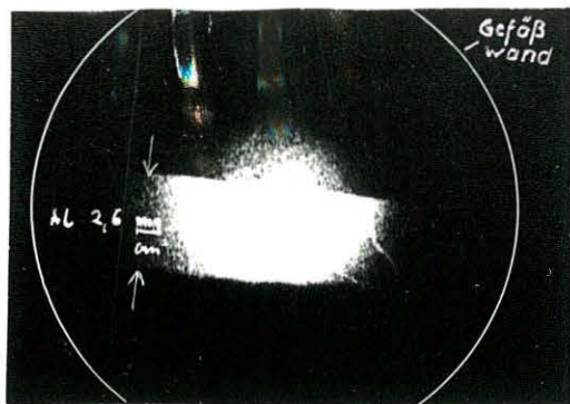
Abb. I, 4. Lochkameraaufnahme der weichen Röntgenstrahlung aus dem Plasma. p_0 = 0,09 Torr H_2 , Absorptionsfolie 2,6 u. 5,2 mg/cm^2 Al
