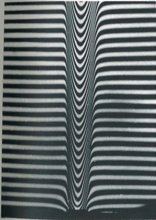
Fig. 2 u. 3 Interferometeraufnahmen des Plasmastrahles in freier Atmosphäre, Argon.
