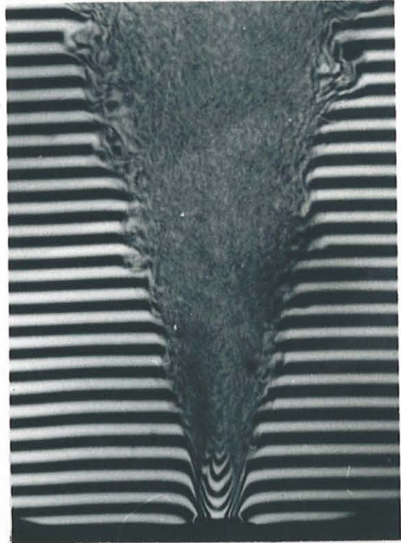
Fig. 2 u. 3 Interferometeraufnahmen des Plasmastrahles in freier Atmosphäre, Argon.
