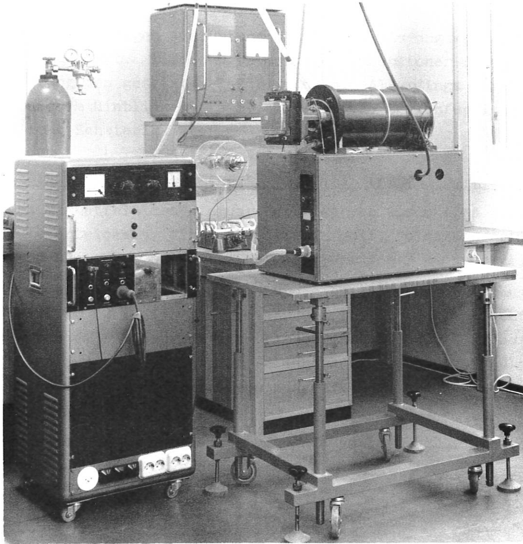
Abb. 3 Bildwandler für Lichtverstärkung u. Kurzzeitfotografie
