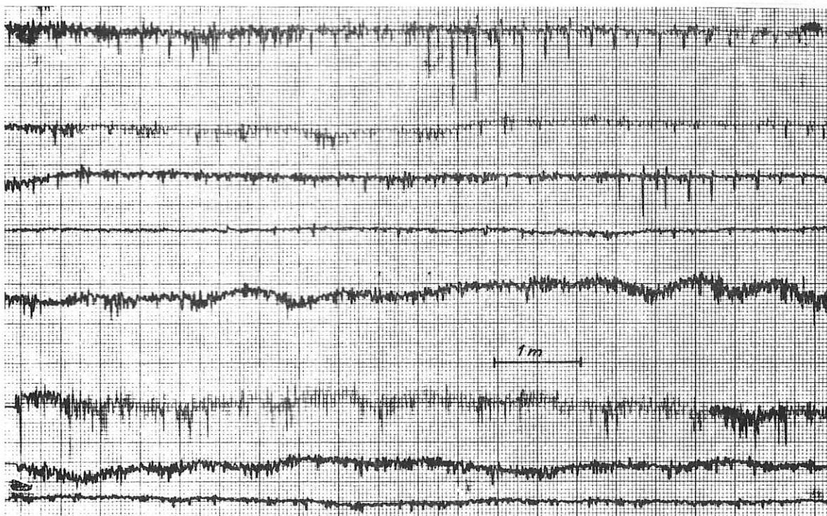
Abb. 33: Ausschnitt aus der Homogenitätsmessung der Kupferplattierung eines Nb 25% Zr-Drahtes
