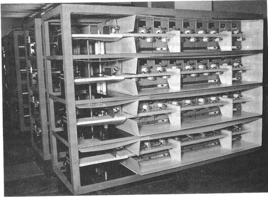
Abb. 7: Ansicht eines 86 kJ-Blocks (1 Gestell) der 690 kJ Stoßstromanlage für Asterix III
