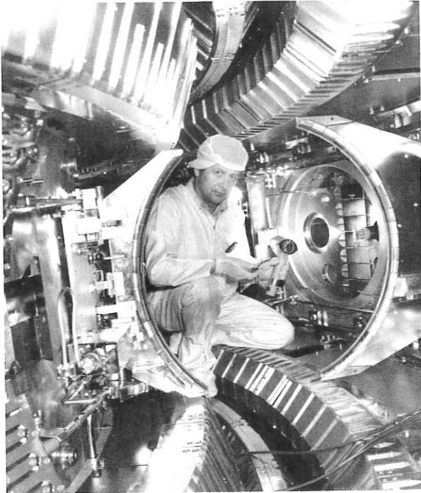
*Blick in das Vakuumgefäß des Tokamak-Experimentes ASDEX: Das Experiment ist mit einem System zusätzlicher Magnetspulen und Plasmanebenkammern – einem sogenannten Divertor – ausgerüstet. Die engen Schlitze ober- und unterhalb der Hauptkammer führen zu den Divertorkammern, in die Verunreinigungen aus den Randschichten des Plasmas abgelenkt werden. Auf diese Weise werden in ASDEX besonders saubere Plasmen mit hohen Energie-Einschlußzeiten möglich.*
