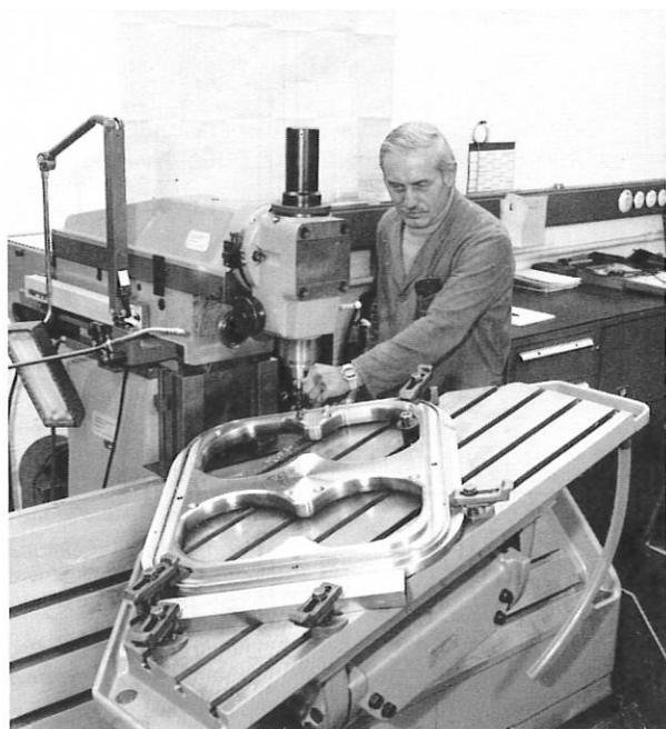
**Abbildung 50:** Eine Kupferblende zum Justieren des Teilchenstrahls der Neutralteilchenheizung wird auf einem Schwenk- und Kipptisch bearbeitet.
