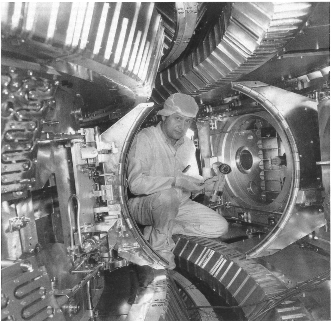
Abbildung 18: Blick in die Vakuumkammer von ASDEX: Die engen Schlitze oben und unten führen in die Divertorkammern. Den Zwischenraum überbrückt auf beiden Seiten ein Limiter, der mehr oder weniger nahe an das Plasma herangefahren werden kann. Auf diese Weise können in ASDEX sowohl Limiter- als auch Divertorentladungen ablaufen.
