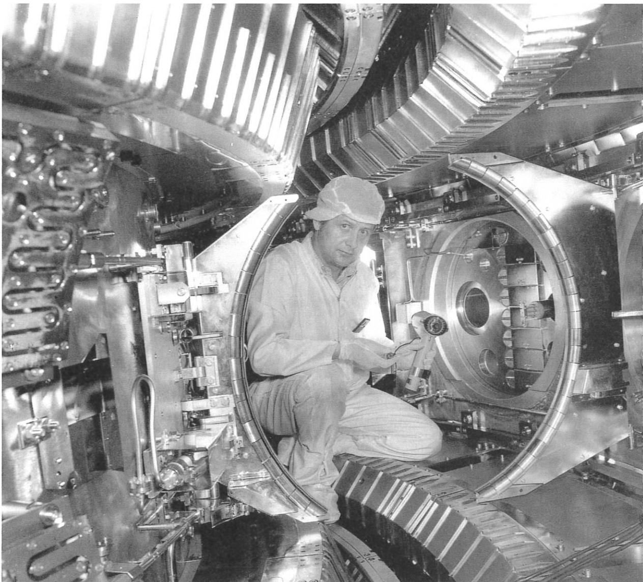
alien mit niedrigem Dampfdruck verwendet werden, die auch bei hohen Temperaturen von 100 bis 300 Grad ausgeheizt werden können.
