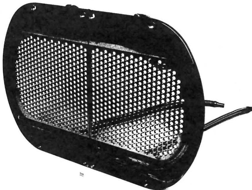
**Abb. 2:** Eine der Elektroden der Neutralteilchen-Heizung. Mehrere 100 Einzelstrahlen beschleunigter Teilchen werden aus den Öffnungen des "Gitters" herausgezogen. Eine ausgefeilte Wasserkühlung hält jede einzelne Öffnung trotz der hohen Wärmebelastung während des Heizpulses auf hundertstel Millimeter relativ zu ihrem Partner im folgenden Gitter konstant.
