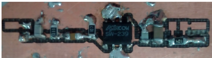
Abbildung A.4: Fotografie des Güteschalters mit dem Platinenmaterial Taconic TLC30
