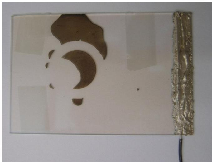
Abb. 4.23.: Durchgebrannte ITO Platte mit der Abmessung 7,5 cm  $\times$  5 cm. Zu sehen ist auch der Abdruck des Abstandsrings.
