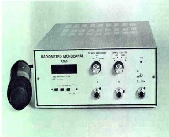
**Figura 7:** Radiómetro monocanal RM-4.
