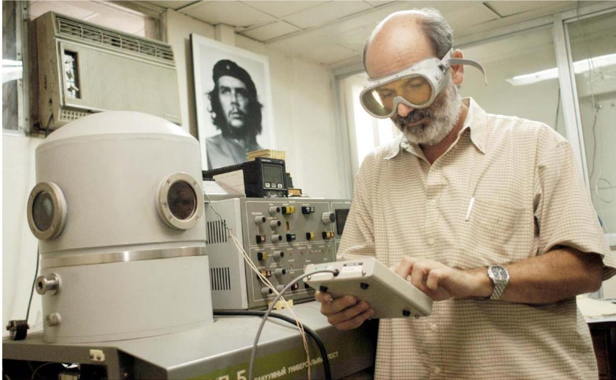
**Figura 2:** Instalación experimental para la deposición de capas mediante laser pulsado (PLD) en el IMRE. Universidad de La Habana.
