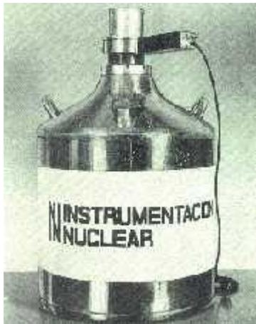
**Figura 8:** Detector de Si de barrera superficial.
