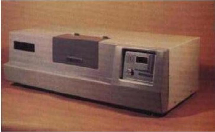
**Figura 6:** Polarímetro digital automático LASERPOL 101M, introducido en la planta de sueros y hemoderivados de La Habana para el control de la producción de sueros de glucosa y otros productos. Con el mismo se controlaba la mayor parte de la producción nacional de estos productos.
