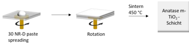
Abbildung 24: : Schematische Darstellung des Spin Coating Vorgangs für die Beschichtung mit 30 NR-D Paste. Der weiße Tropfen und die weiße Schicht stellt die Titanatpaste dar.
