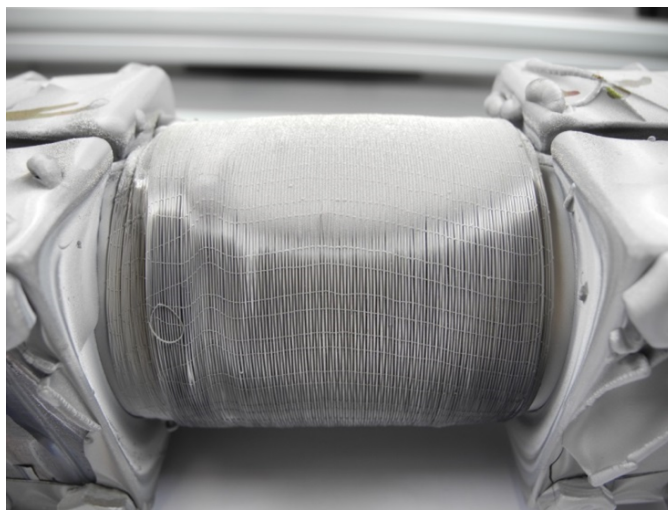
Abbildung 6.6: In FRED hergestelltes W_f/W auf dem Heizrohr. Es wurde nur an der Oberseite Wolfram abgeschieden.
