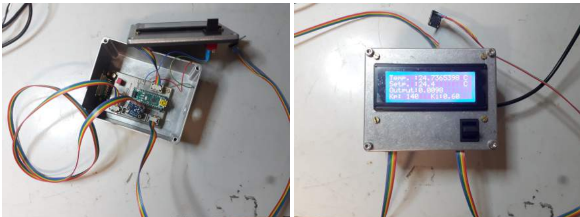
(a) Offene Regelbox mit Platine und zwei an- (b) Regelbox mit Steuerdisplay, Versorgung geschlossenen BMP388 's. weiterhin über USB.
