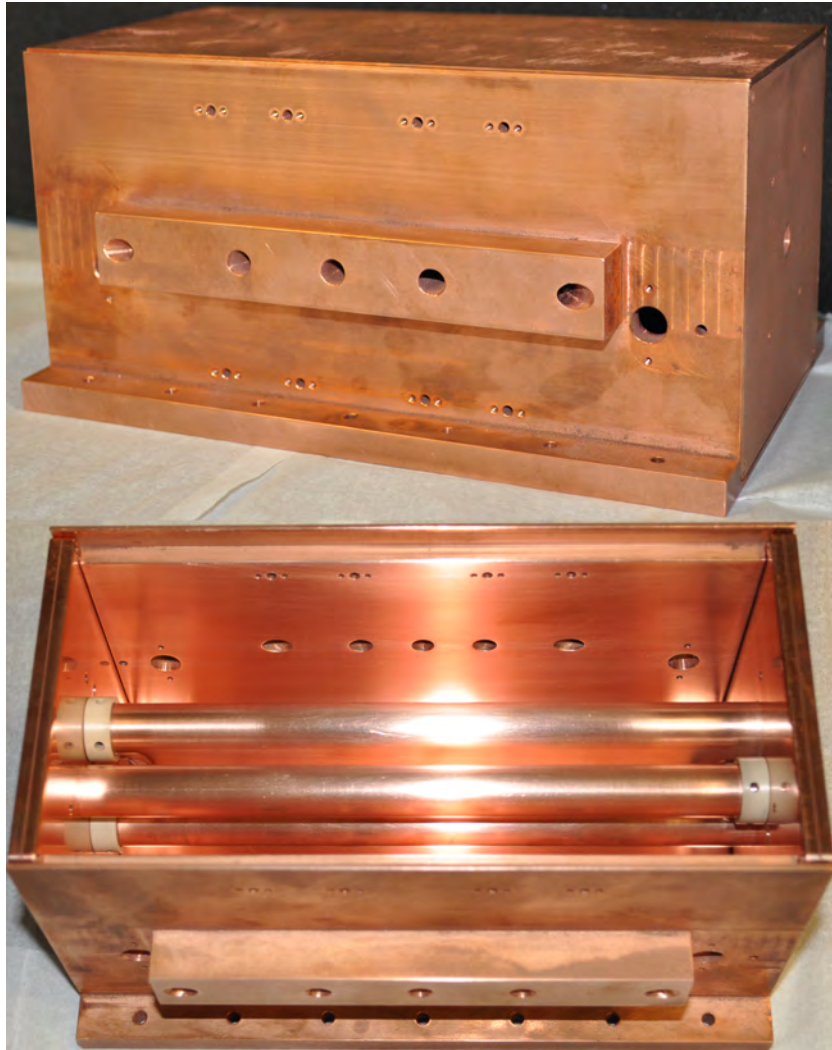
Abbildung 3.2: Fotografien des Hohlraumresonators. Oben ist der Resonator in seitlicher Ansicht zu sehen. Unten ist er in Draufsicht ohne Deckel mit eingebrachter Elektrodenstruktur gemäß der linearen Paul-Falle abgebildet.
