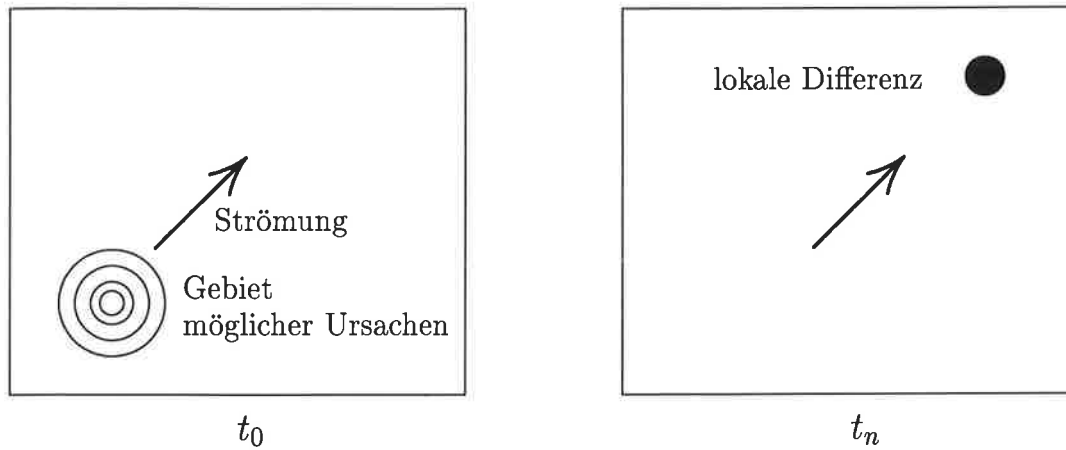
Abbildung 5: Adjungiertes Modell : Advektion und Diffusion von Einfluß (Integration von t_n zu t_0 )
