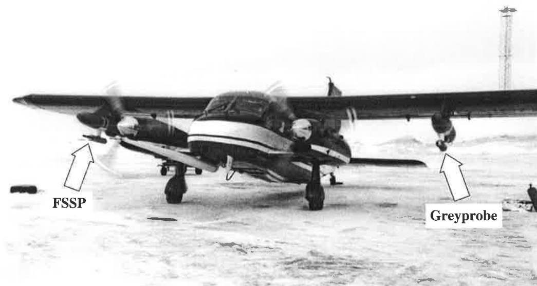
Abbildung 4.5: Das Flugzeug DO-128 der Technischen Universität Braunschweig mit den Teilchenmeßgeräten FSSP und Greyprobe.
