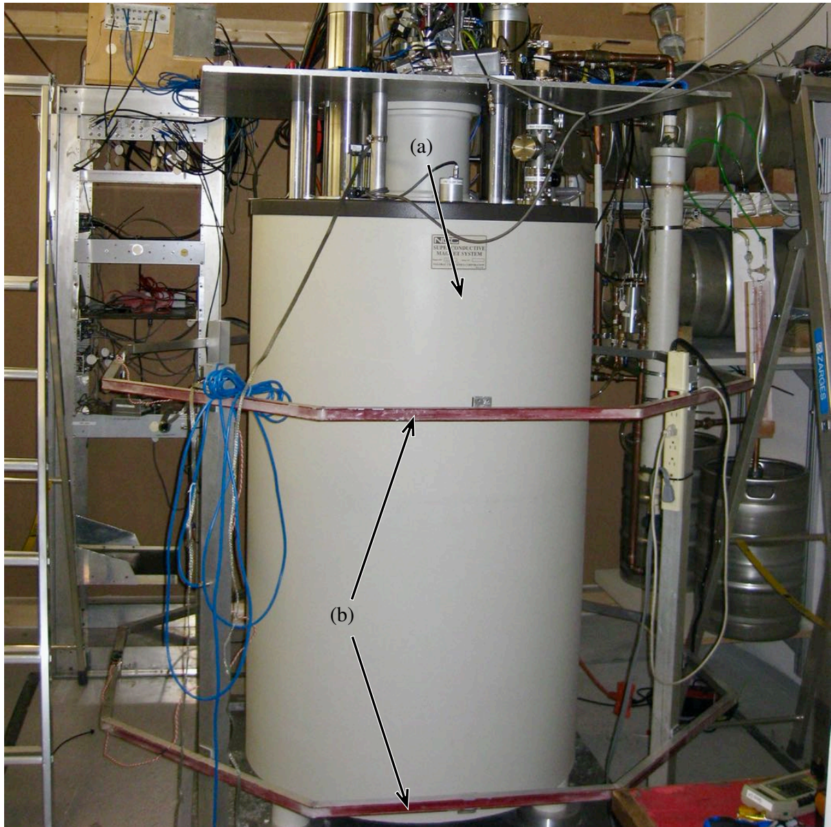
Abb. 5.2: Neben dem supraleitenden Magnet (a), in dessen Inneren sich die Abschirmspule sowie der Fallenturm des Experiments befindet, wurde zusätzlich eine Helmholtz-Spule (b) verwendet, um eine homogene äußere Magnetfeldstörung zu erzeugen
