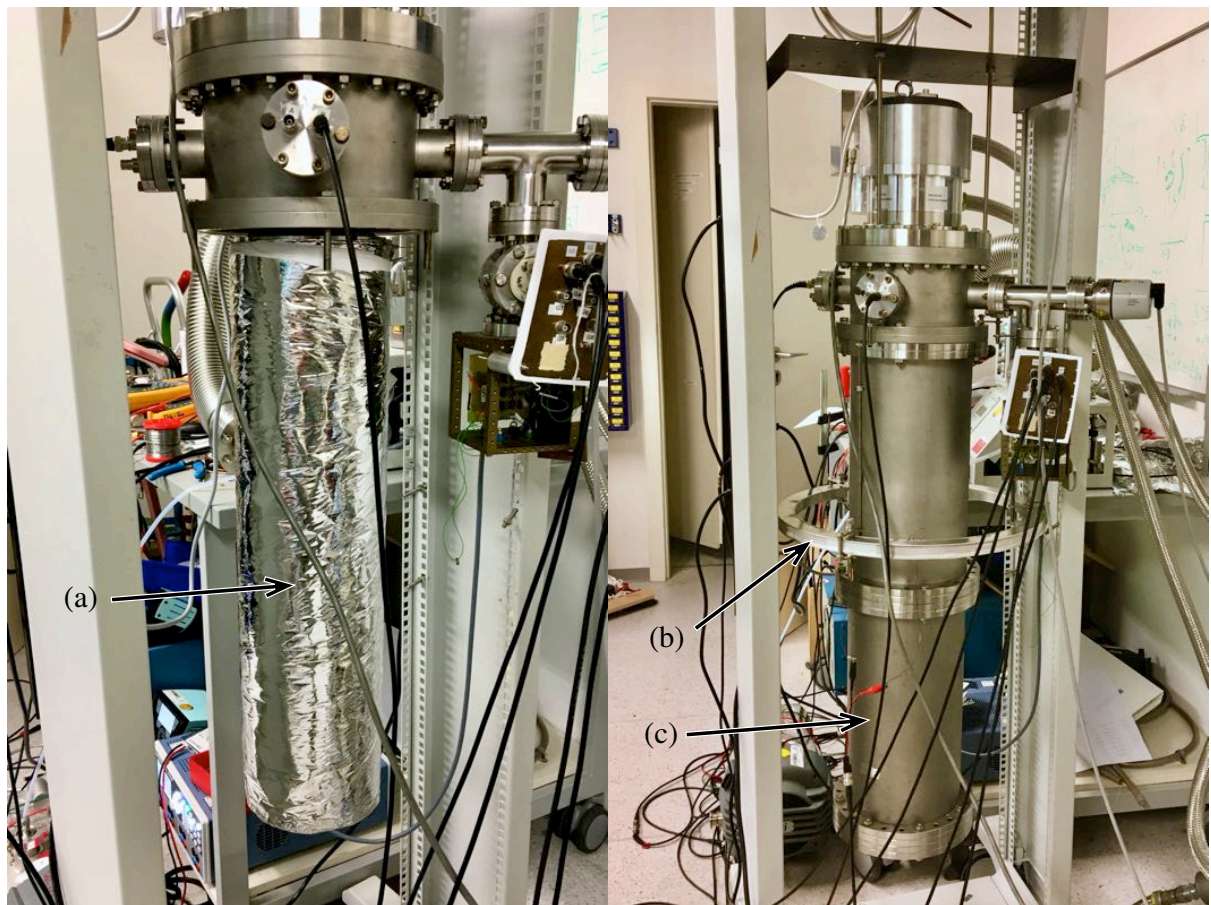
Abb. 4.2: Um die Fallenkammer und den Kaltkopf von Strahlungswärme zu isolieren, wurde ein Hitzeschild (a) verwendet. Ein externes Magnetfeld wurde durch eine Ringspule (b) erzeugt. In der Vakuumkammer (c) befinden sich alle weiteren Bestandteile des Aufbaus.
