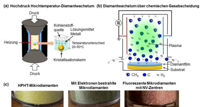
Abbildung 2. HPHT-Wachstum und CVD-Herstellung von Diamant und Bildung der NV-Zentren im Diamant.
