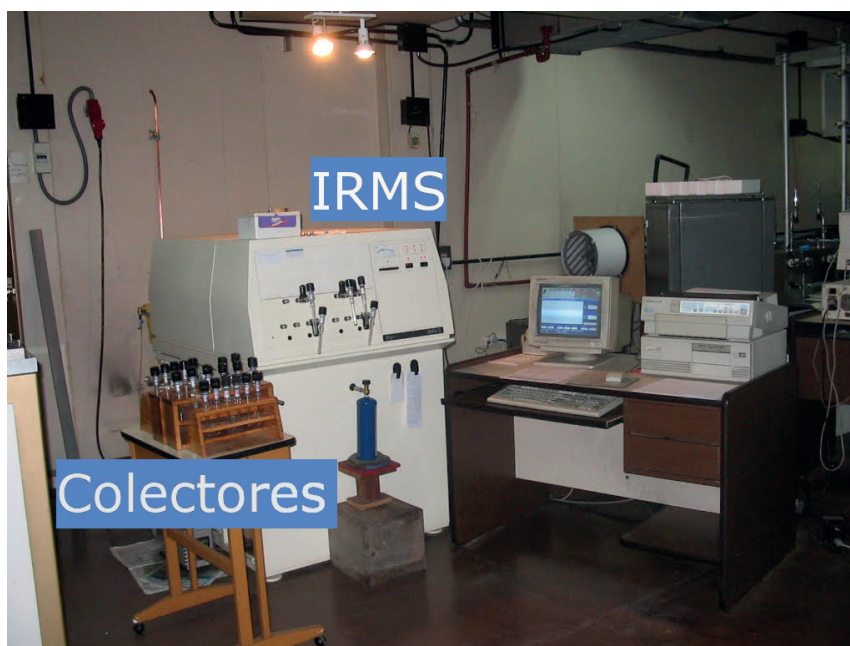
Figura 4. Finnigan Mat Delta S de doble entrada utilizado en INGEIS para medir la composición isotópica del carbono y el oxígeno en carbonatos biogénicos.
