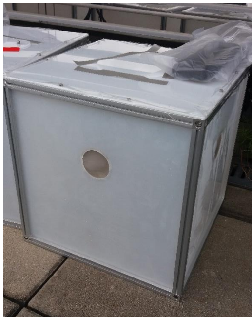
Abbildung 7 Installierte Versuchsboxen mit Membran für Luftzirkulation (Mitte) und angeschlossenem Akku (schwarzer Balken in Plastiktüte)
