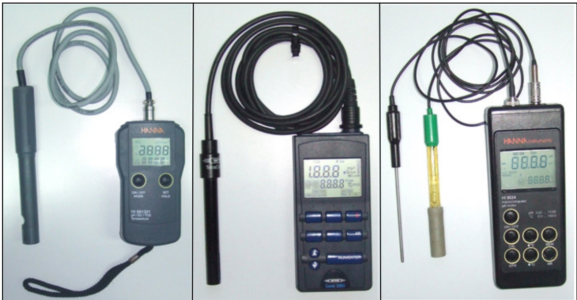
Abb. 8: Messgeräte des Moor- Monitorings.
