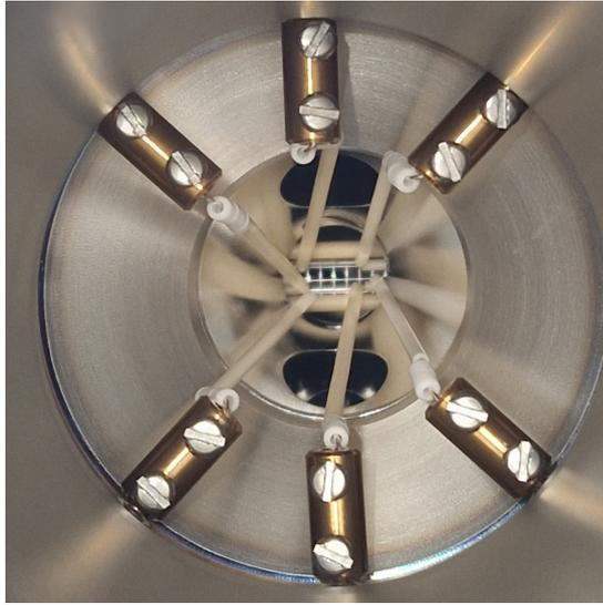
Abbildung 3.5: Fotografie der Verkabelung der Driftröhren durch den Durchführungsflansch, welcher seitlich an der EBIT angebracht ist. Die Elektronenkanone würde sich auf der linken Seite, der Kollektor auf der rechten Seite befinden. Die Kabel sind mit Keramikröhrchen isoliert, damit in der Nähe der zentralen Driftröhre und des Drahtgitters möglichst viel optischer Zugang bestehen bleibt. Kurz vor den Vakuumdurchführungen sind die Kabel mit Keramikperlen isoliert.
