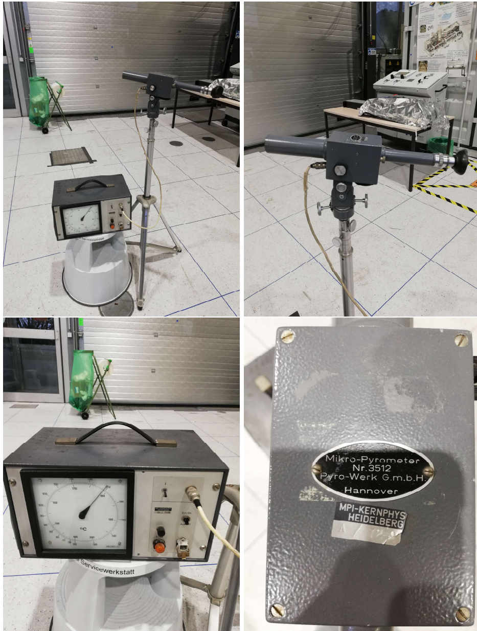
Abbildung 29: Im ersten Bild ist die gesamte Apparatur zu sehen. Oben rechts nur das Objektiv; links unten das Messgerät selbst und unten rechts das Markenschild.
