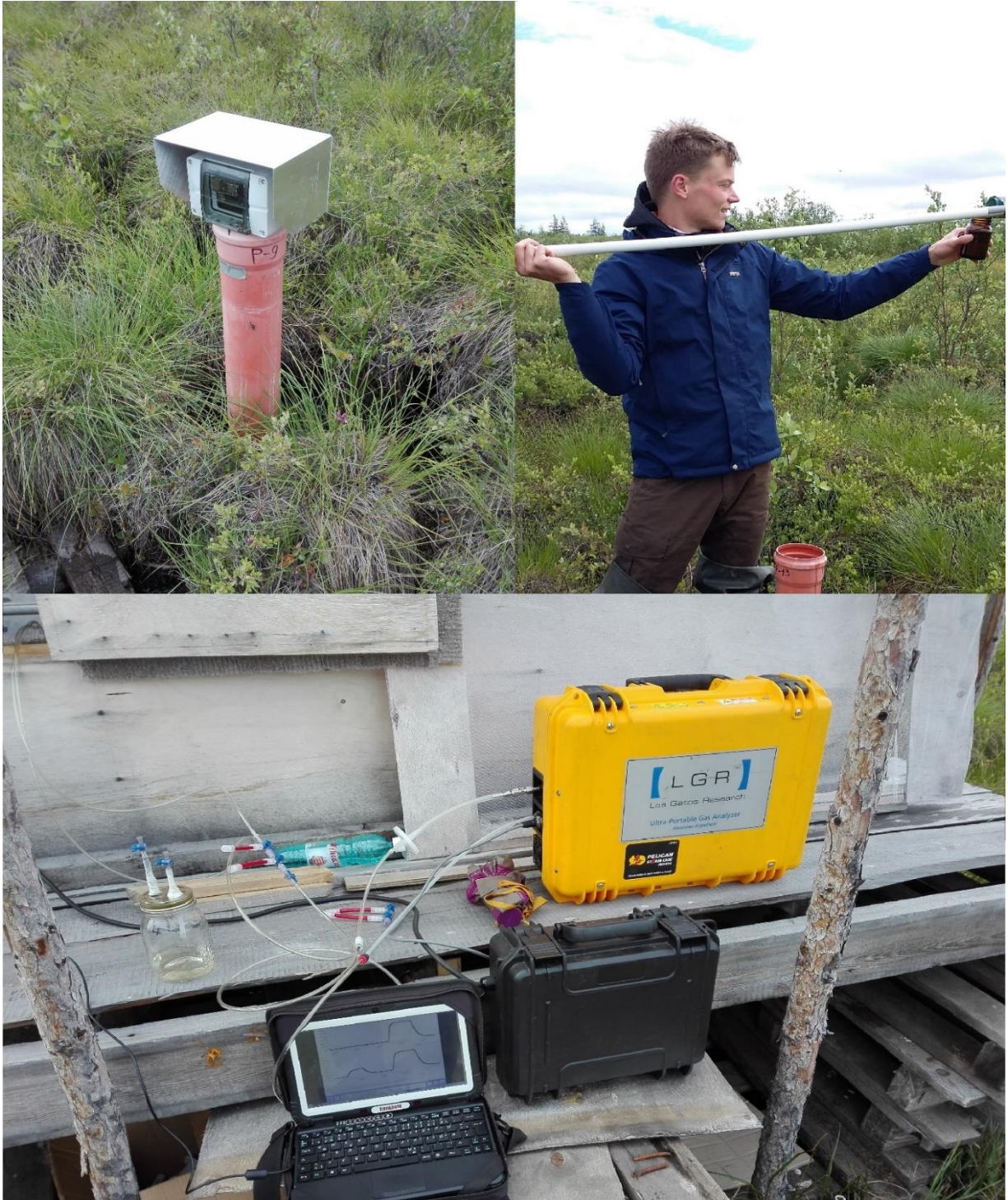
Abbildung 5: Links oben: Standort P-09 zwischen Büscheln von Carex appendiculata . Rechts oben: Wasserentnahme mit der Schöpfvorrichtung und Befüllen eines braunen Glases. Unten: Analyseaufbau mit dem Analysator, Laptop und einem Probenglas vor der Hütte bei Standort P-04. Quelle: Boelck und Schauer; 2017
