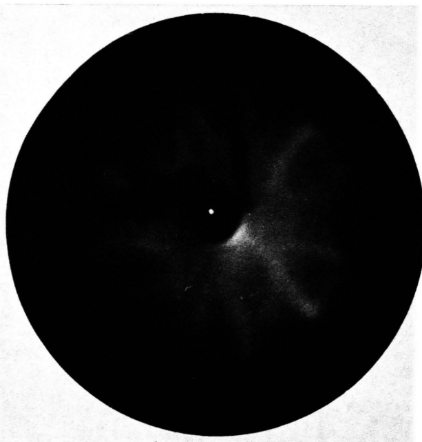
Abb. 3. Beugungsbild für \theta = \frac{1}{2} . a) U = 34 V; b) U = 8 V mit Zusatzreflexen infolge Mehrfachstreuung.
