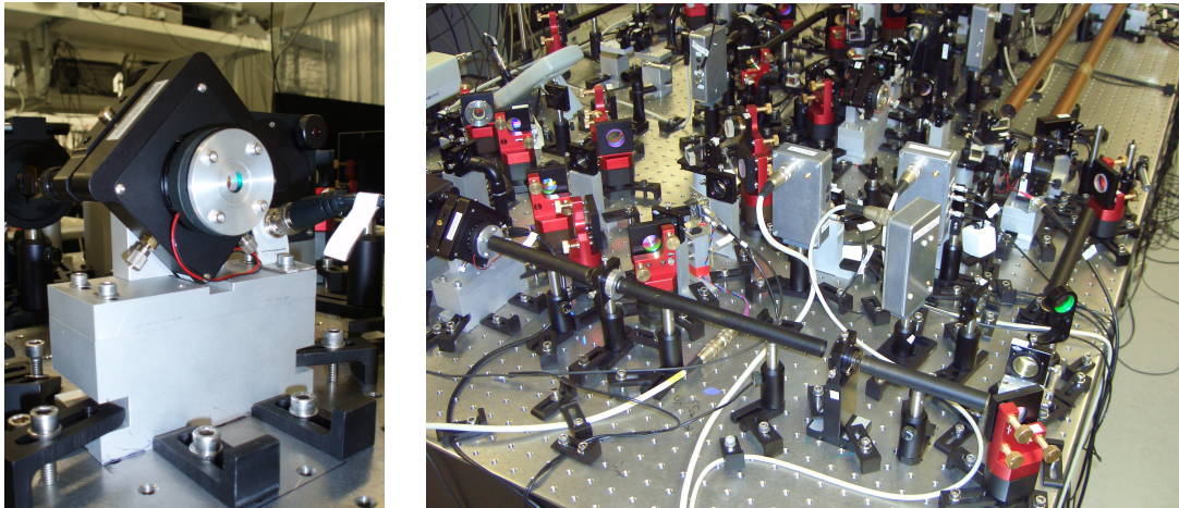
Abbildung 5.10.: Fotografien des Twin-Signal Recycling Spiegelhalters (links) und eines Ausschnitts aus dem experimentellen Aufbau, der den TSR-Resonator beinhaltet (rechts). Die geschwärzten Messingrohre im rechten Bild dienen der Abschirmung des Resonators von störenden Einflüssen aus der Umgebung. Deutlich im Vordergrund des Bildes zu erkennen sind zwei der Blenden, die als Strahlreferenz zu Justagezwecken in den TSR-Resonator integriert worden sind.
